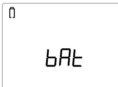
Bild 2.1: Anzeige „Batterie entladen“
