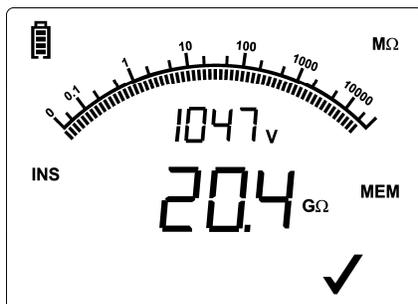
Bild 5.3: Beispiel für ein Ergebnis einer Isolationswiderstandsmessung
